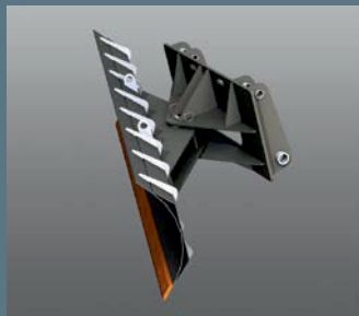
Снежный отвал с механической системой поворота
