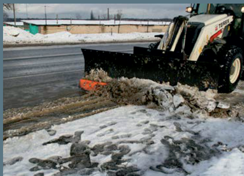
Снежный отвал с защитой от наезда на препятствие
